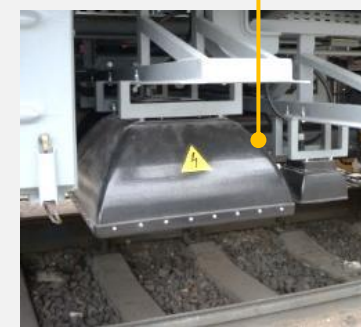
МЕХАНИЗИРОВАННАЯ СИСТЕМА ГЕОРАДИОЛОКАЦИИ ЗЕМЛЯНОГО ПОЛОТНА
