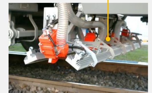
ВИДЕОКОНТРОЛЬ СОСТОЯНИЯ РЕЛЬСО- ШПАЛЬНОЙ РЕШЕТКИ
