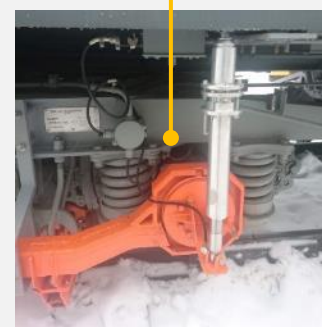
СИСТЕМА ОЦЕНКИ СТАБИЛЬНОСТИ ПУТИ В ВЕРТИКАЛЬНОЙ ПЛОСКОСТИ
