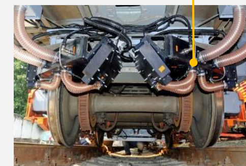
КОНТРОЛЬ ПАРАМЕТРОВ РЕЛЬСОВ И ШИРИНЫ КОЛЕИ В РАЗНОАГРУЖЕННОМ СЕЧЕНИИ
